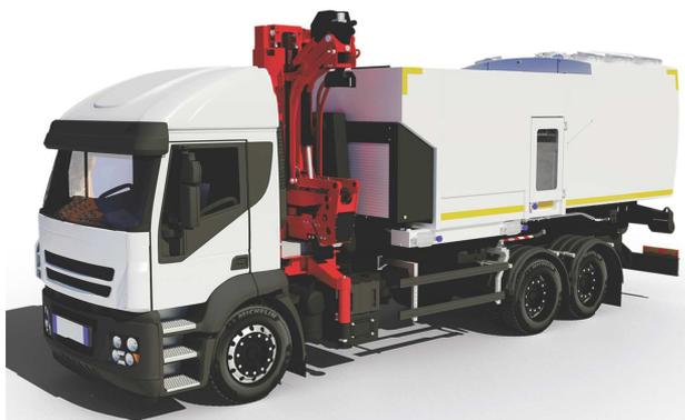
Il cassone lava-contenitori scarrabile è realizzato completamente in acciaio Inox esclusa la parte di supporto scarrabile. La cisterna per le acque bianche ha una capacità di circa 5.000 litri, mentre quella per le acque reflue ha una capacità di circa 6.000 litri. Le dotazioni comprendono la camera di lavaggio in acciaio Inox completa di filtri e dispositivi di aspirazione, la testa rotante ad alta pressione (100 - 150 bar) per
